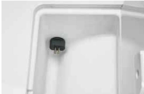
La qualité de l'eau distillée utilisée est garantie par le **capteur de conductivité intégré dans le réservoir** et par une gestion efficace des messages d'avertissement/alarme. En cas d'eau inappropriée, le stérilisateur prévient l'opérateur par des messages spécialement prévus à cet effet et bloque automatiquement le fonctionnement en cas de risque de dégâts.
